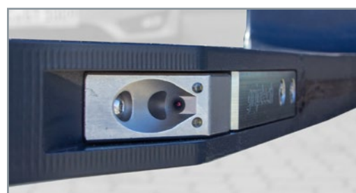
↑ Durch die Vollintegration in die Kontur ist die Kamera bestens geschützt.
